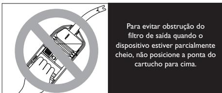
A válvula de admissão (ponta do cartucho) foi projetada para impedir que a matéria succionada retorne pela ponta quando a ponta do cartucho estiver voltada para baixo.
