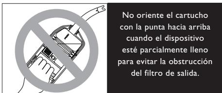
La válvula de entrada (punta del cartucho) fue diseñada para impedir que la materia succionada fluya de vuelta a través de la punta del cartucho cuando ésta apunte hacia abajo.
