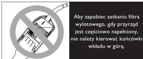
Zawór wlotowy (końcówka wkładu) ma za zadanie zapobiegać przepływowi zassanej treści z powrotem przez końcówkę, gdy jest ona skierowana w dół.
