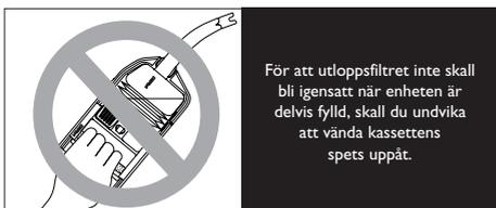
Inloppsventilen (kassettspetsen) är konstruerad för att hindra returflöde av uppsugget material genom spetsen när den vänds nedåt.
